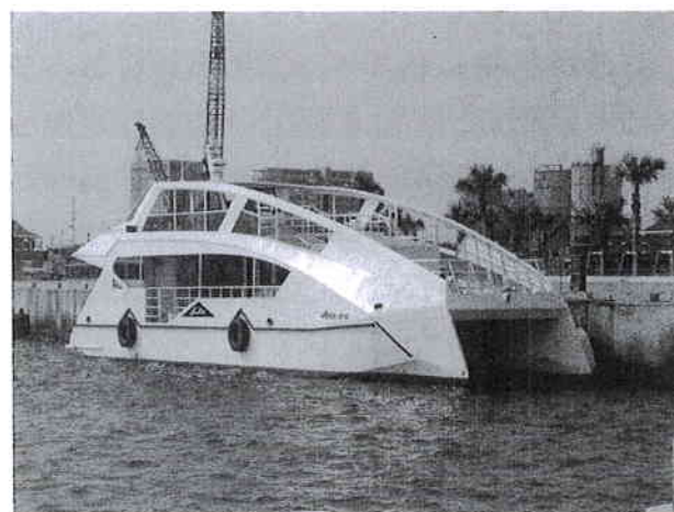
石垣島の電気推進遊覧船vibes one バッテリー搭載で、ディーゼル発電機も搭載するハイブリッド船
